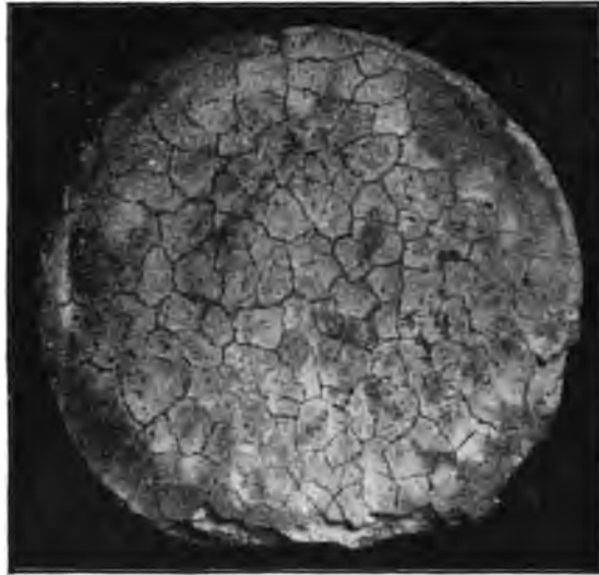
Fig. 32. — Aspect d'une galette de ciment dont le foisonnement est dû à la présence d'un excès de chaux.
